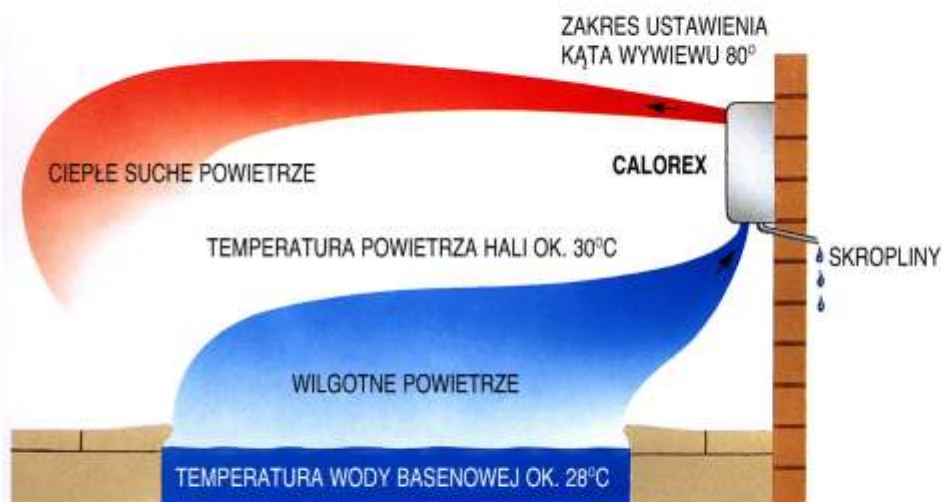
SCHEMAT PRZEPIŹYWU POWIETRZA
